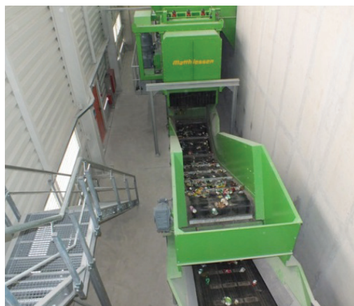
Slika 3.: Sestavni deli sortirne linije za mehansko obdelavo ostanka odpadkov.
